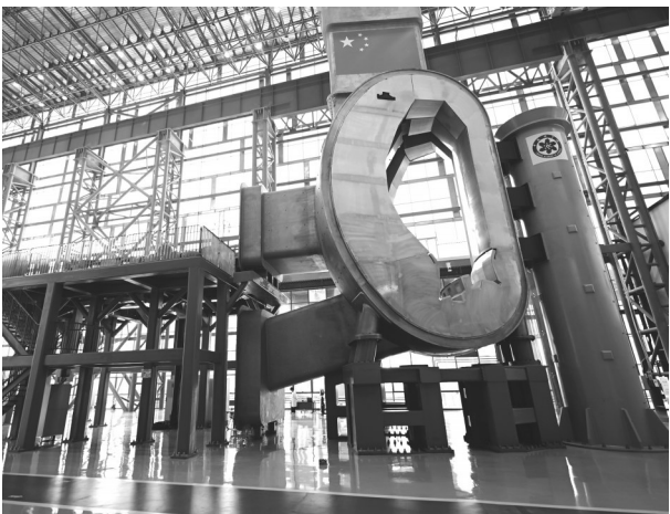
3月9日拍摄的聚变堆主机关键系统综合研究设施八分之一真空室及总体安装系统主体平台。新华社记者 周牧 摄
