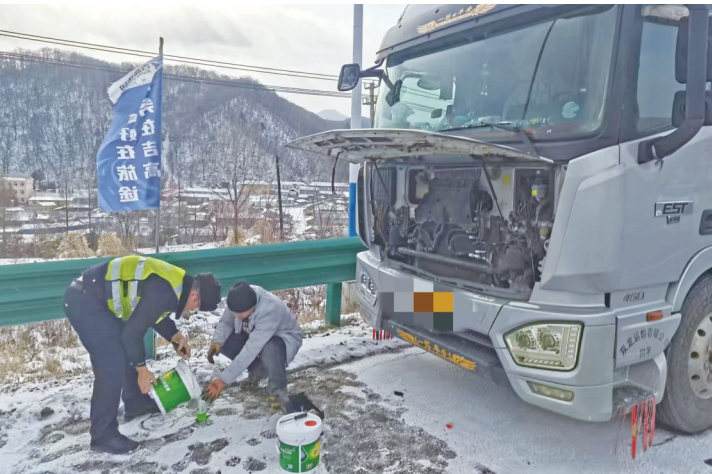
为故障车辆加注防冻液 高速公安供图
