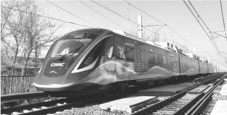
图为我国首列氢能源市域列车在位于吉林省长春市的中车长客试验线进行运行试验。(中车长客股份公司供图)
