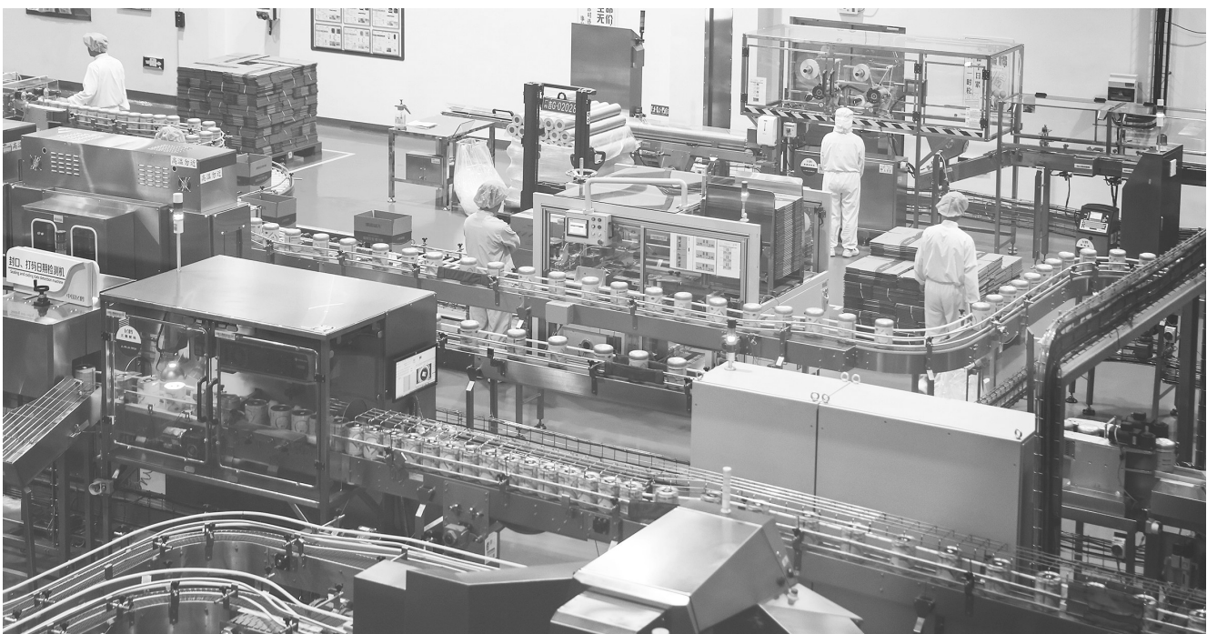
飞鹤(吉林)乳品有限公司位于镇赉县,公司按照食药行业GMP标准设计,建设10万级国际标准化净化车间,引进国际一流制粉生产设备和奶粉包装线,采用国际最先进蒸汽杀菌技术,保证了奶中营养成分不损失。目前,工厂实现全智能化生产,年可处理鲜奶15万吨、加工生产婴幼儿配方奶粉2万吨。 记者 李晓明 摄
