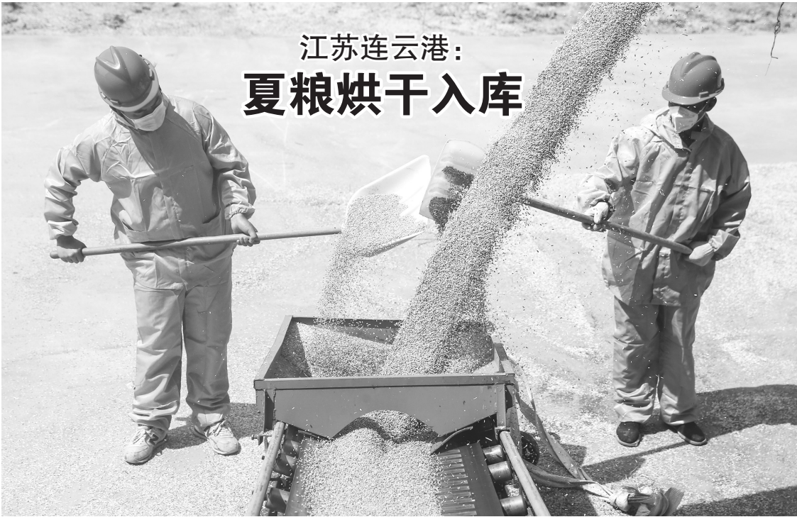
6月13日，在江苏连云港市青口盐场仓储中心，工人用传输机传送烘干后的小麦入库。 近日，江苏连云港市全力抓好夏粮烘干收储工作，各地仓储中心烘干塔24小时满负荷运转。收获的小麦经过筛选除杂烘干后，经过输送带送入粮仓。 新华社发 王健民 摄
