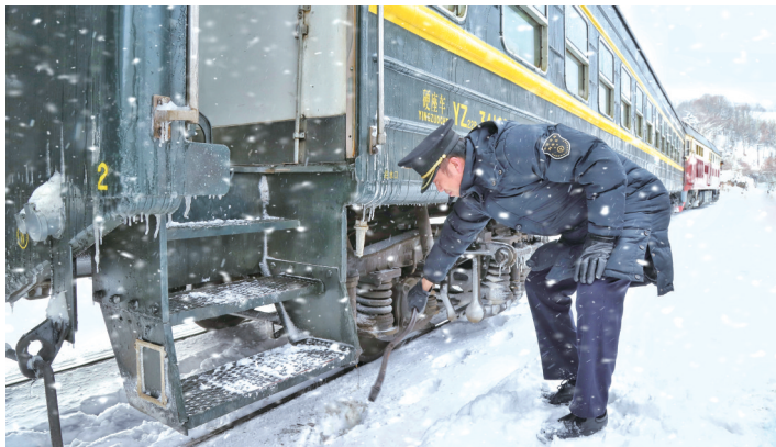
客运员为列车除冰 长春客运段供图
