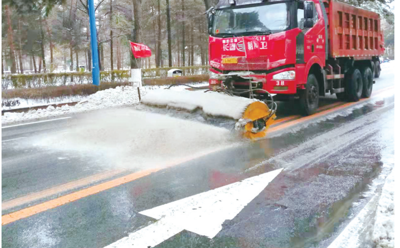
前置滚刷除雪车大显神威
