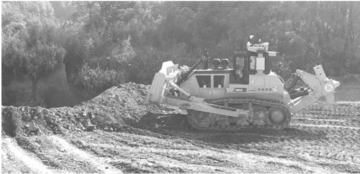
远程遥控推土机正在推土作业(无人机照片) /新华社记者 郭杰文 摄
