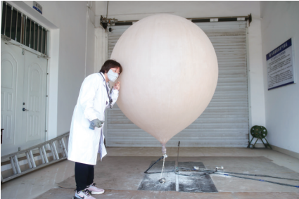
充气过程要观测和倾听氢气球是否有气体泄漏
