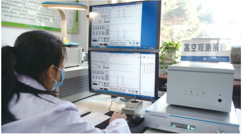
电脑实时显示探空气球采集到的数据
