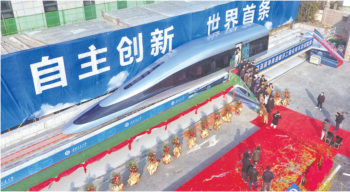
高温超导高速磁浮工程化样车外观及试验线
