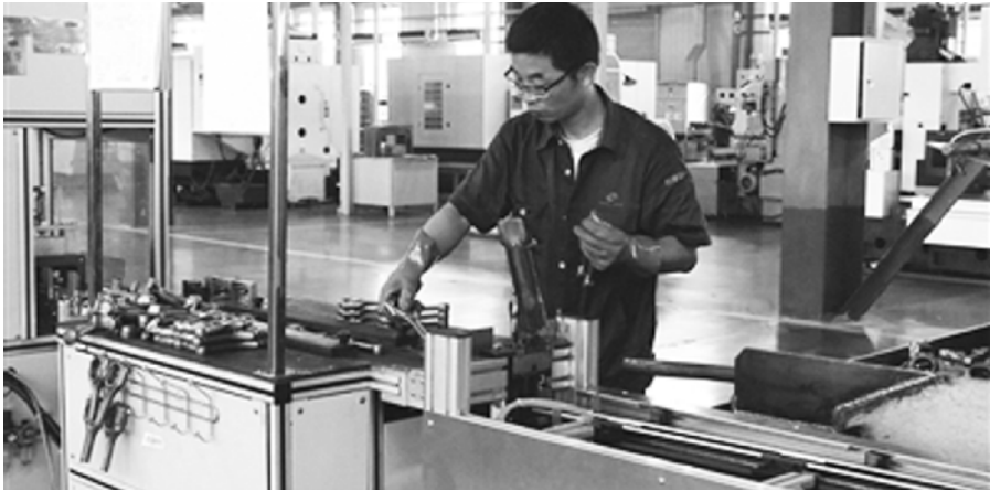
白城中一精锻股份有限公司员工在连杆检测线上细心检测产品质量
