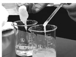
放入84消毒液后,蚕丝几乎完全溶解,聚酯纤维却没变化
