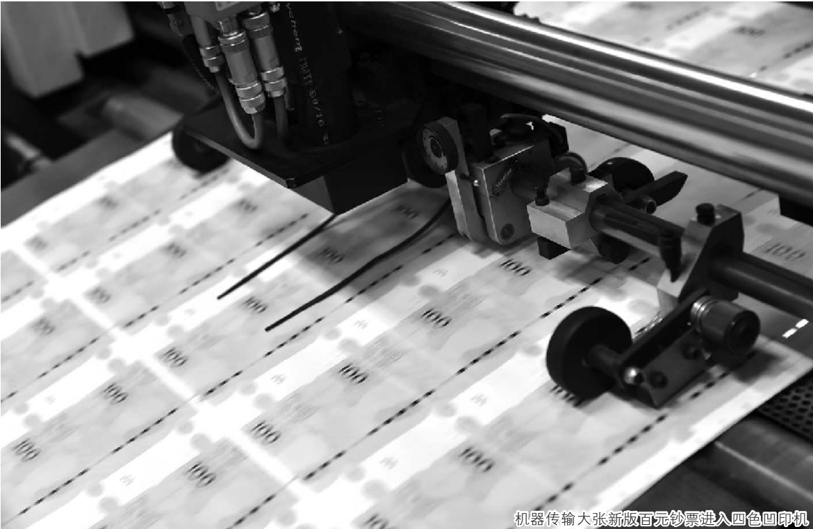
机器传输大张新版百元钞票进入四色凹印机
